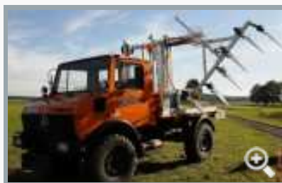
Spezialfahrzeug zur Suche von Minen
